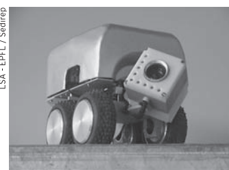
Scrapy-Doo, un robot développé à l'EPFL et destiné à inspecter les canaux de ventilation
